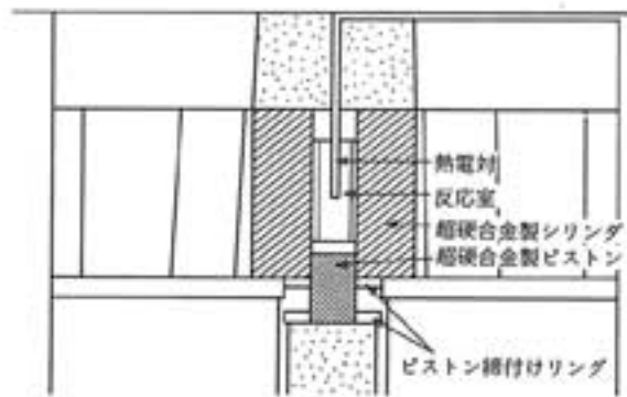
図 2.1-8 ピストン-シリンダ形高圧装置
